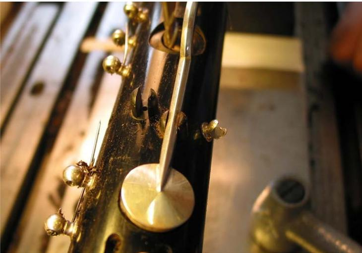
Der korrekte Sitz der Klappe wird geprüft
