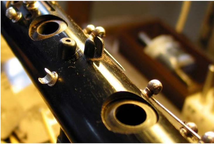
Die zweite Führung ist eingeklebt
