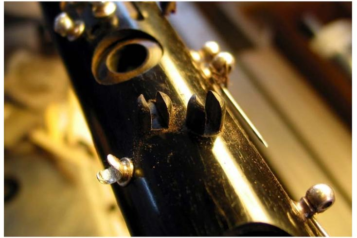
Die zweite Führung ist fertig geätzt
