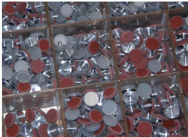
Material in den unterschiedlichsten Härten, von 60-30 Shore. Doch je weicher das Silikon, desto höher die Adhäsionskräfte, die dazu führten, dass die Polster 'klebten'. Ganz zuletzt sind wir zum allererst entdeckten roten Silikon zurückgekehrt und verarbeiten es jetzt in einer Art Sandwich.
