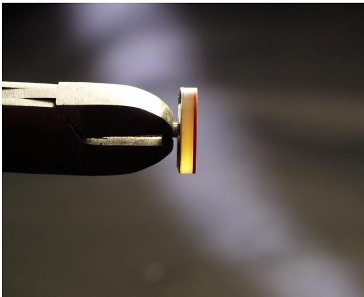
Verklebung perfektioniert. Diese spezielle Art des (roten) Silikons enthält über 20 % Quarzmehl und hochdisperse Kieselsäure. Wir sprechen in grober Vereinfachung von 'elastischem Glas'. Das ist auch der Grund, weshalb wir an diesem Material in der Deckschicht bis heute festgehalten haben:
